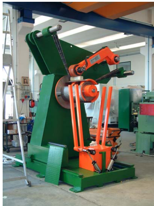
Bild 2 und 3: Abwickelhaspel SMC60 mit 6 to. Tragkraft, 2000mm Coilaussendurchmesser und Ladestuhl mit pneum. Kippsicherungen
