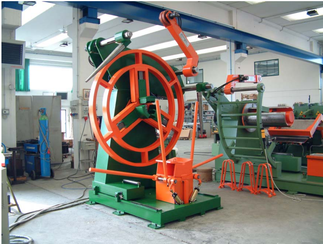
Bild 1: Abwickelhaspel SM40 mit 4 to. Tragkraft, 2000mm Coilaussendurchmesser und Ladestuhl mit pneum. Kippsicherungen
