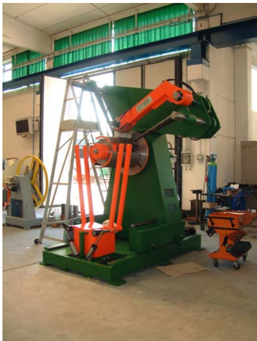
Bild 2 und 3: Abwickelhaspel SMC60 mit 6 to. Tragkraft, 2000mm Coilaussendurchmesser und Ladestuhl mit pneum. Kippsicherungen
